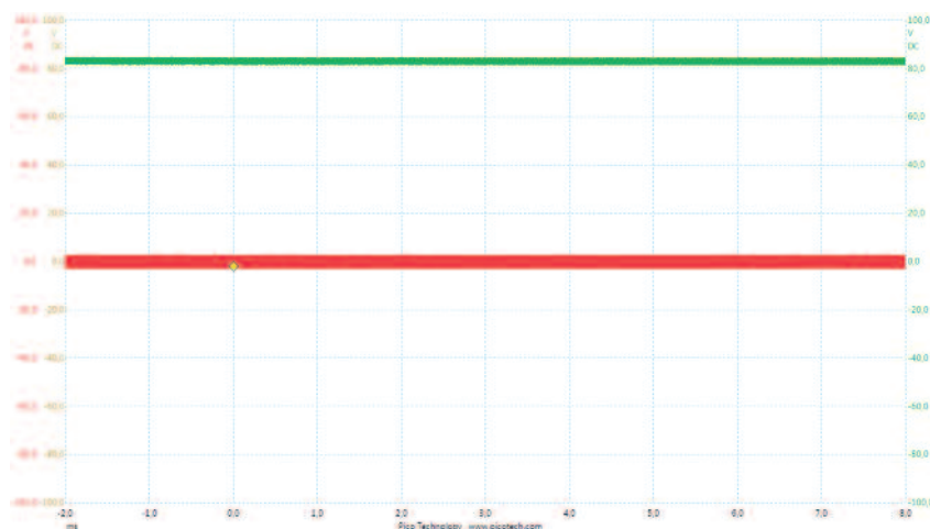
Bild 5: Jeder Ausgang der Einzelbrücken hat einen Offset gegenüber dem zentralen Minus des Netzteils auf halber Betriebsspannungshöhe – der Lautsprecher liegt zwischen beiden Einzelbrücken und hat somit einen schwebenden Minuspol ohne DC-Offset
